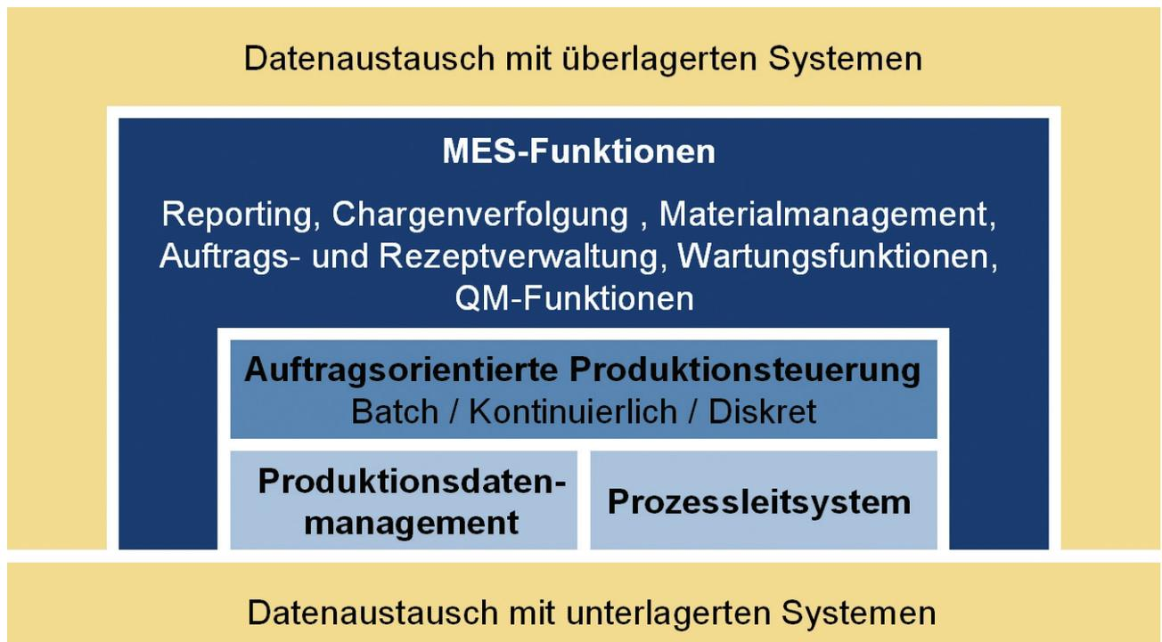
Systemarchitektur eines Prozessleitsystems mit integrierter MES-Funktionalität.
