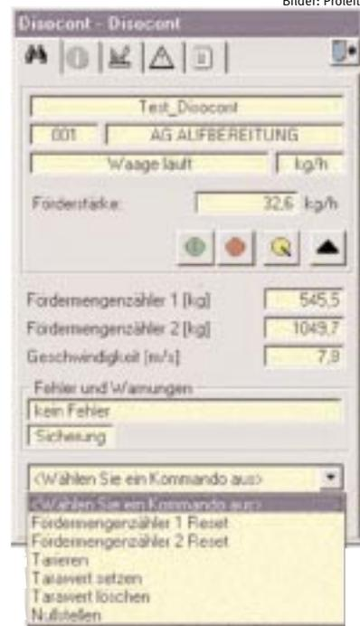
Waagenklassen entstanden in Zusammenarbeit mit Schenck. Das Bild zeigt den Bediendialog der Bandwaage Disocont.
