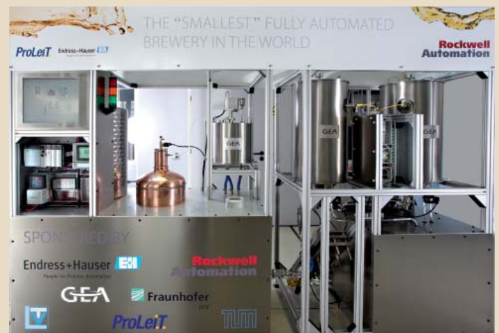
Abb. 1 Mini-Brauerei mit Zwei-Geräte-Sudwerk und Gärkeller
